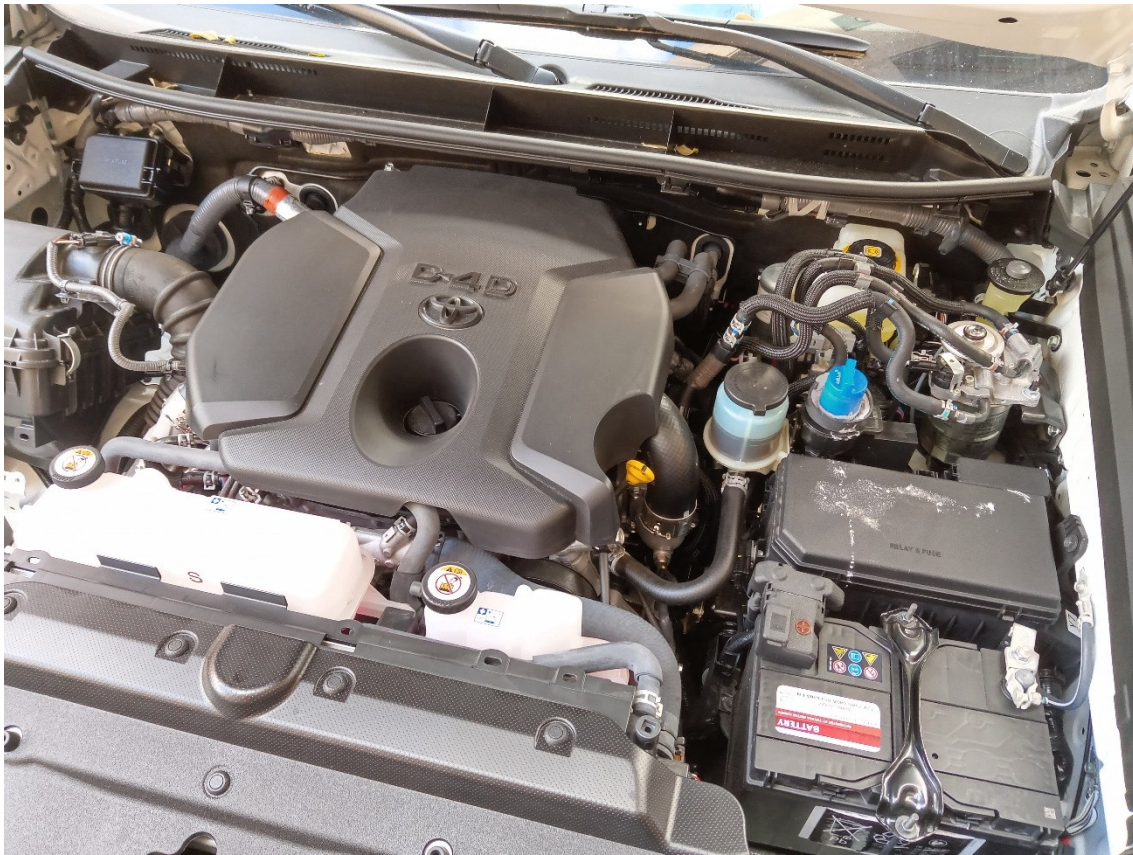
Foto A8. Vista del motor amb capó obert. El tap blau és l'AdBlue
