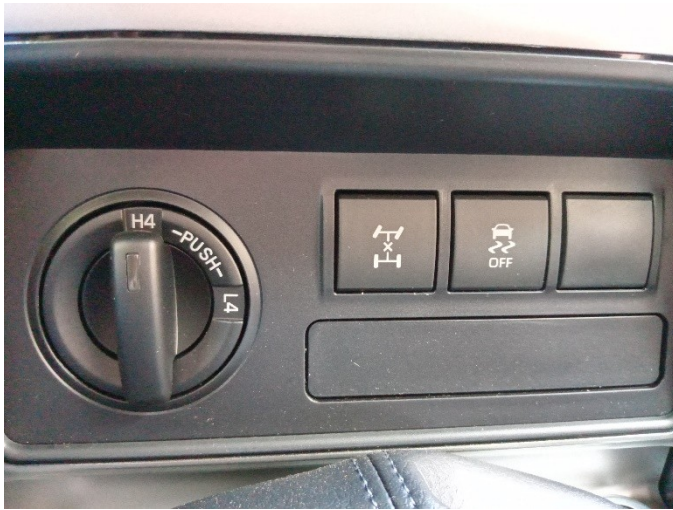
Foto A 1. Activar reductora (L4); botó desbloqueig diferencial central. Botó VSC off (pag.140 Guia Usuari)
